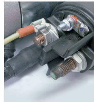
Ilustracja 4: Podłączony przewód do zacisku 45; zasilany prądem jest tylko silnik elektryczny.
