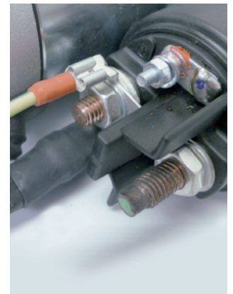
Abbildung 4: Angeschlossenes Kabel an Klemme 45; es wird nur der Elektromotor bestromt
