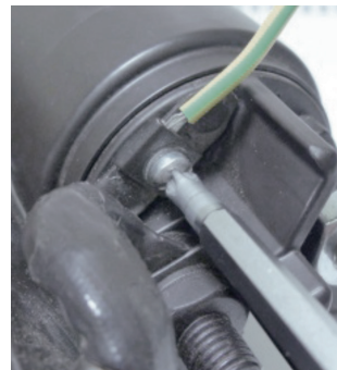
Ilustracja 3: Przewód podłączony do zacisku 50 włącznika elektromagnetycznego
