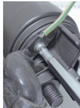
Abbildung 3: Angeschlossenes Kabel an Klemme 50 des Magnetschalters
