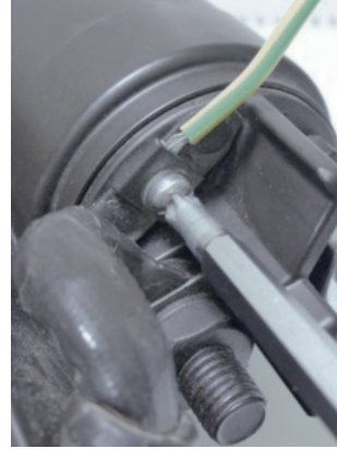
Resim 3: Manyetik şalterdeki Terminal 50'ye bağlı kablo
