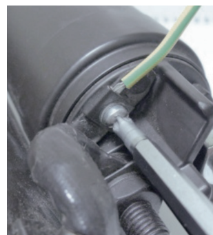
Рисунок 3: Кабель, подключенный к клемме 50, соответствующей электромагнитному реле
